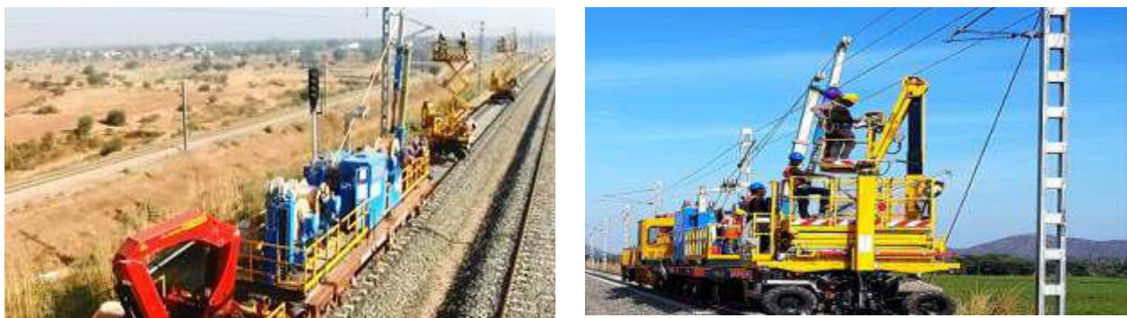
Fig. 10: OHE wiring train
