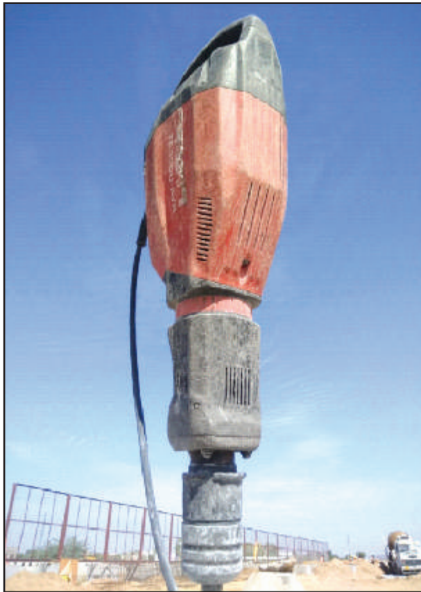
Fig.-3 HILTI TE AVR Breaker for augering
